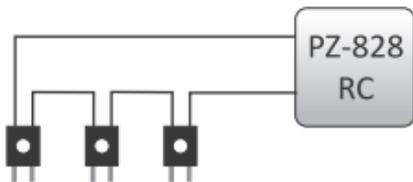
b) **Parallel** (für ein alternatives Kontrollsystem des Flüssigkeitsstandes in vielen Punkten) mindestens eine beliebige der angeschlossenen Sensoren muss kurzgeschlossen werden.
